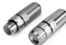
Разработан специально для требований в сфере производства напитков: высокий тип защиты IP 67, контакты с золотым напылением и плоская поверхность для надёжной передачи электроэнергии и сигналов во влажной окружающей среде.
