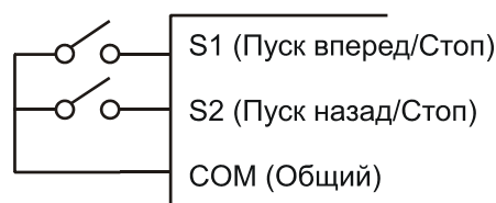
Рисунок 4.3а. Двухпроводная схема «Пуск вперед/Стоп–Пуск назад/Стоп»
