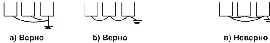
Рисунок 3.13. Примеры заземления: несколько приводов
