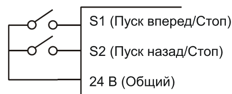
Рисунок 4.3а. Двухпроводная схема «Пуск вперед/Стоп–Пуск назад/Стоп»
