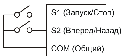
Рисунок 4.3б. Двухпроводная схема «Пуск/Стоп–Вперед/Назад»
