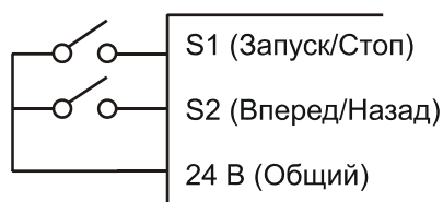
Рисунок 4.3б. Двухпроводная схема «Пуск/Стоп–Вперед/Назад»
