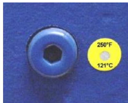
Рис. 3-11. Расположение наклейки-индикатора температуры
