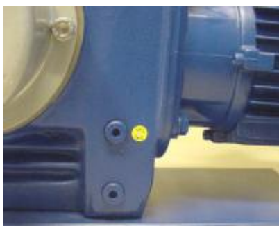
Рис. 3-11. Расположение наклейки-индикатора температуры
