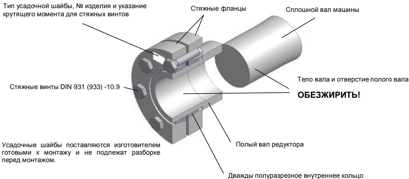
Рис. 3-8. Полый вал с усадочной шайбой
