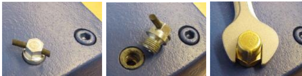
Рис. 3-1. Удаление пробки для выпуска воздуха и установка пробки для сброса давления
